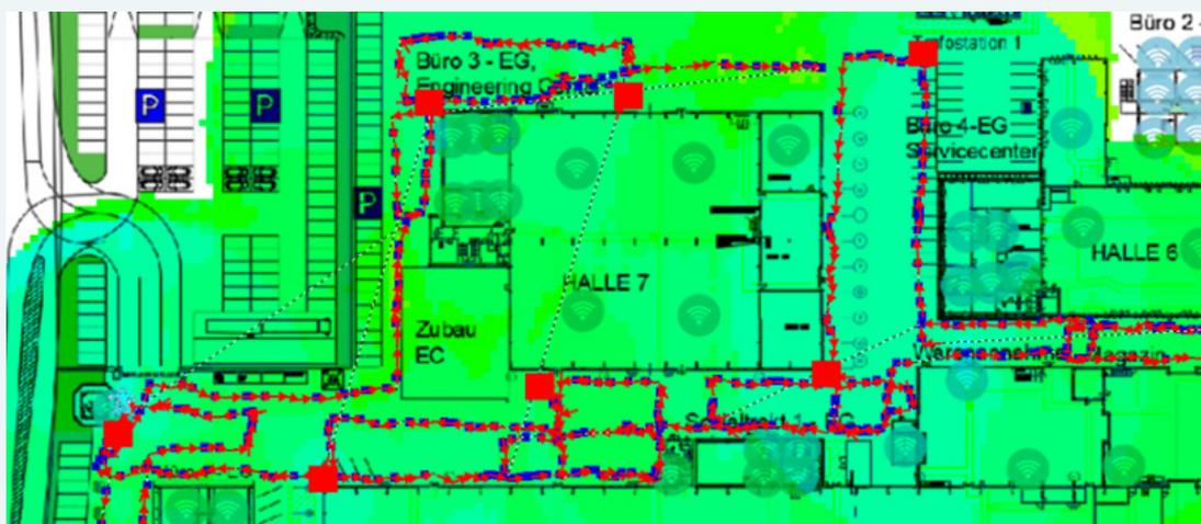
*Veranschaulichung einer Outdoor-WLAN-Ausmessung. Die roten Quadrate symbolisieren die Montagepunkte der Outdoor-APs.*
